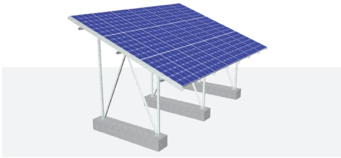
MRac地面光伏防水支架系统 适用于中小型地面光伏电站的安装,该产品具有高度预安装特性,抗风雪能力强,并能在前后左右及上下方向上对整个系统进行调节,大大降低了对安装精度的要求。通过次梁和下锁组件的设计使得系统具有良好防水特性,专业的结构设计在确保系统强度前提下,有效地提高了工程安装的时效。
